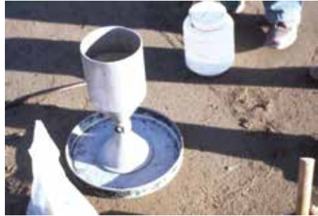
Imagen N° 8 - Volumenómetro de cono de arena
