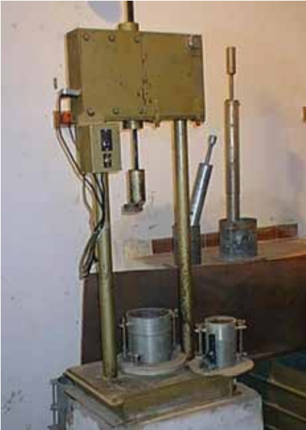
Imagen N° 6 - Compactador mecánico, moldes y compactadores manuales
