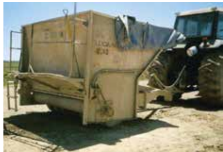
Imagen N° 26 – Distribuidor de cemento tirado con tractor
