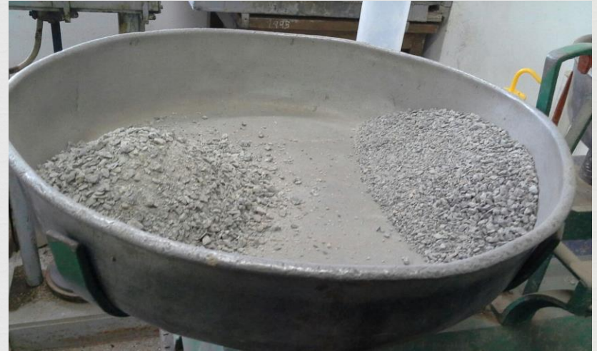
Material A y B – Tamaño Pasa T.N°4 50% de cada uno para ensayo
