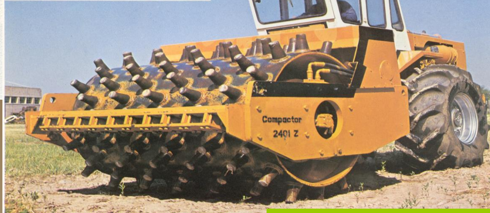
Pata de cabra autopropulsado
